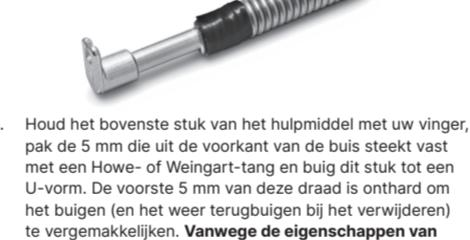
6. Houd het bovenste stuk van het hulpmiddel met uw vinger, pak de 5 mm die uit de voorant van de buis steekt vast met een Howe- of Weingart-tang en buig dit stuk tot een U-vorm. De voorste 5 mm van deze draad is onthard om het buigen (en het weer terugbuigen bij het verwijderen) te vergemakkelijken. **Vanwege de eigenschappen van de draad moet deze bij het installeeren in één keer goed worden gebogen; bijbuigen zal de draad doen breken.**
